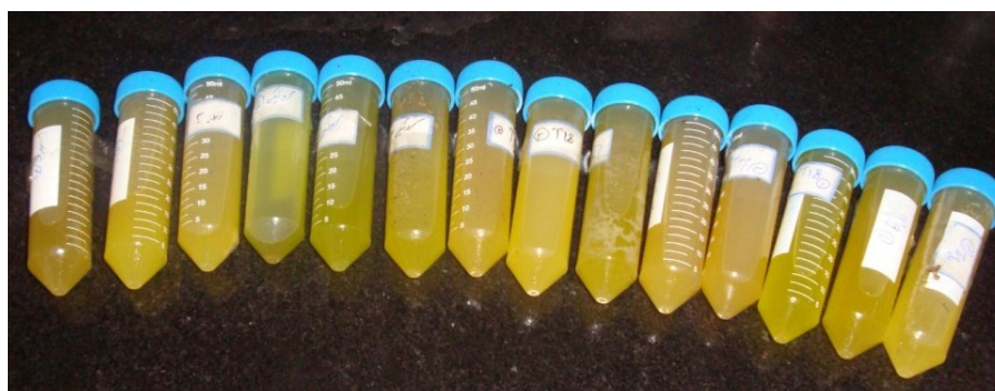
شکل ۳. نمونه‌های روغن زیتون جدا و خالص‌سازی شده با استفاده از سانتریفیوژ.
