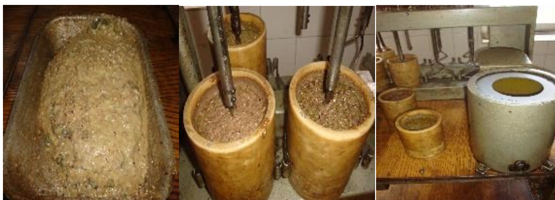
شکل ۲. تهیه خمیر از میوه‌های زیتون آسیاب شده، انجام مالاکسیون و سانتریفیوژ نمونه‌ها (به ترتیب از سمت چپ).
